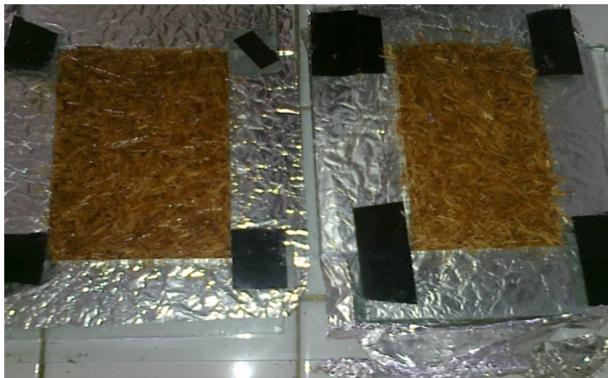
Hasil papan komposit sabut kelapa susun acak dalam cetakan.
